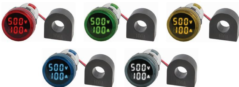
Цифровые индикаторы Omix R30-AV2-1 предназначены для отображения действующих значений силы тока и напряжения в однофазных сетях переменного тока. Используются в качестве альтернативы светосигнальным лампам 22 мм при контроле питания и нагрузки в шкафах автоматики или распределительных шкафах.
